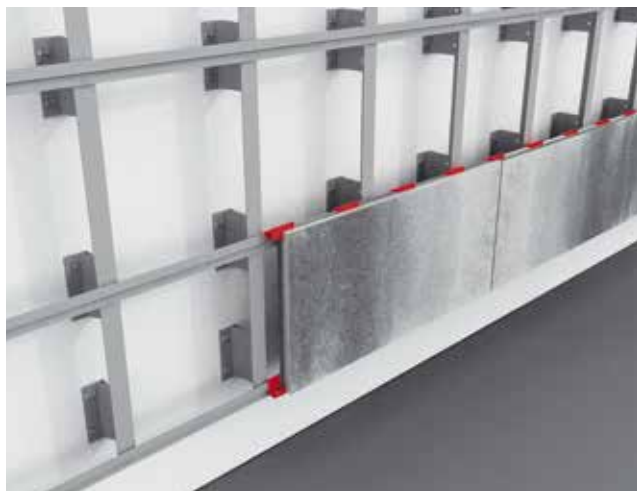
Obr. č. 7 a 8 Postup osazení obkladových fasádních desek
