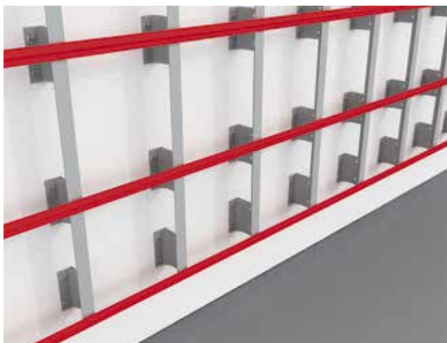
Obr. č. 4 Montáž vodorovného Z profilu
